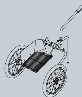
Carrello (optional) per trasportare l'aspiratore, dotato di ruote snodabili ed indipendenti che consentono di tenere la macchina in piano anche su terreni in pendenza. La griglia di scarico agisce da setaccio migliorando ulteriormente la pulizia del prodotto aspirato. Dimensioni: 130 x 80 x 88 cm. Imballo: 52 x 56 x 23 cm.
